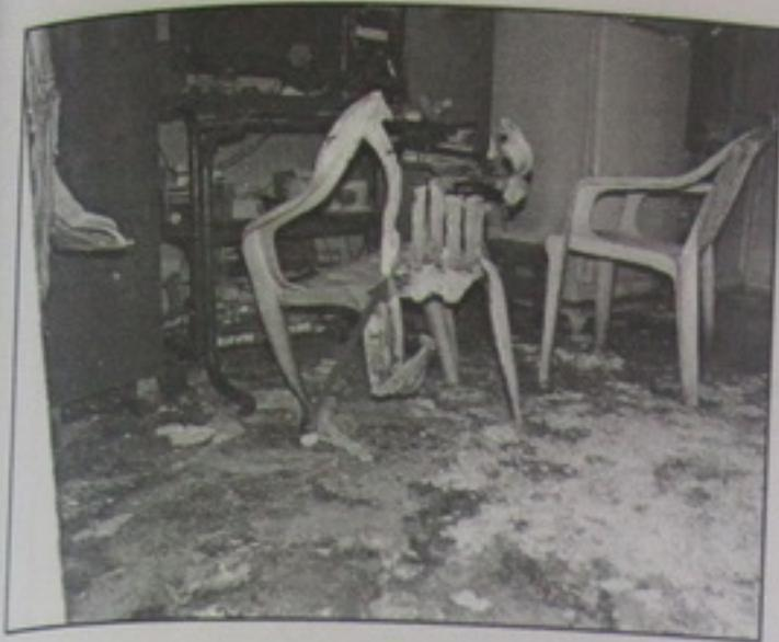
c) La silla que se encontraba frente a la computadora y de espalda a la puerta de entrada, se encontraba afectada por la propagación del calor, presentando las mayores afectaciones de abajo hacia arriba y de derecha a izquierda, lo que nos indicaba que el calor incidía en esa dirección.
